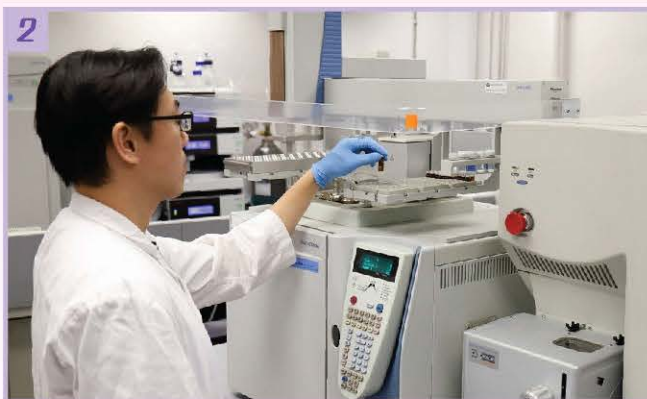
2 政府化驗所人員使用氣相色譜/串聯質譜儀分析蔬果類食品中除害劑殘餘含量
