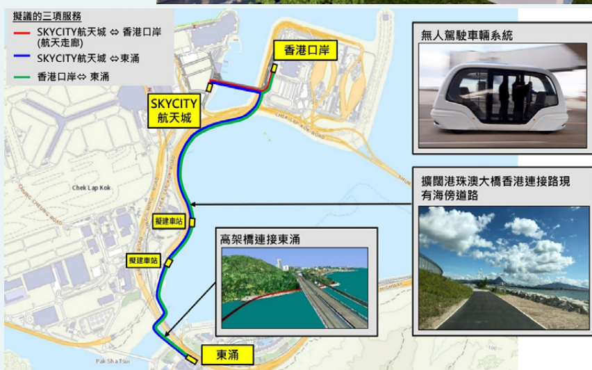
「航天走廊」自動駕駛運輸系統走線圖及構想圖
