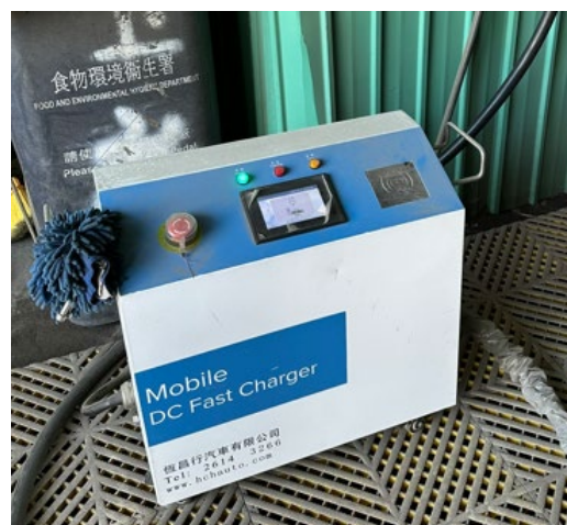
30 千瓦直流充電裝置 #2
