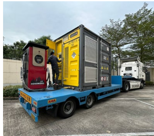
在將軍澳的 200 千瓦移動直流充電設施及移動儲能系統（參與機構自資安裝）
