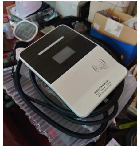
放於電動車內的 22 千瓦交流充電裝置
